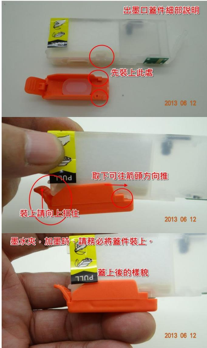
● 左圖圈圈處，是蓋子的底扣。
